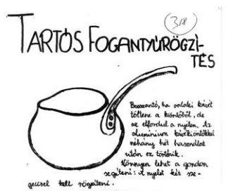
1. kép „Bosszantó, ha valaki kávé-t töltene a kiöntőből, de az elfordul a nyélén. [ ] Könnyen lehet a gondon segíteni: a nyelet két szegeccsel kell rögzíteni”.
