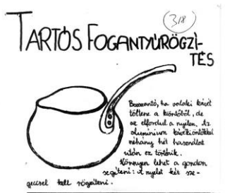
1. kép „Bosszantó, ha valaki kávé-t töltene a kiöntőből, de az elfordul a nyélen. [ ] Könnyen lehet a gondot segíteni: a nyelét két szegeccsel kell rögzíteni”.
