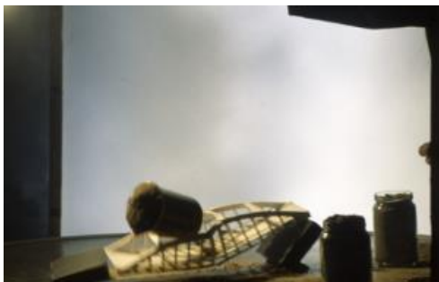
15. kép Hídmodellezés adott távolságra korlátozott anyagmennyiségből.
