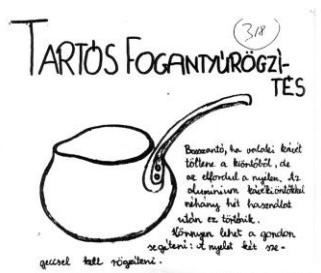
1. kép „Bosszantó, ha valaki kávé-t töltene a kiöntőből, de az elfordul a nyélén. [ ] Könnyen lehet a gondot segíteni: a nyelet két szegeccsel kell rögzíteni”.
