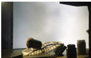
15. kép Hídmodellezés adott távolságra korlátozott anyagmennyiségből.
