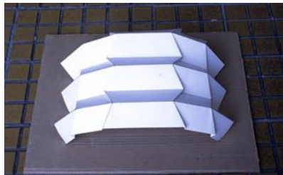
15. kép Hídmodellezés adott távolságra korlátozott anyagmennyiségből.
